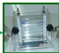
3. 將電泳槽對準定位凹痕中。將不銹鋼蝴蝶扣鎖上。
