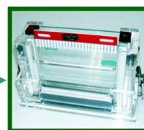
5. 注入第二層膠體溶液並置入齒梳。
