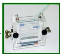
4. 注入膠體溶液。待凝固後，將水倒出。
