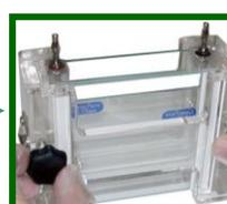
10. 電泳分離後，取出電泳槽，並鬆開螺絲，取出玻璃。
