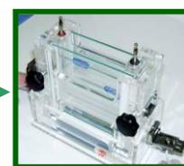
6. 待膠體凝固後，鬆開扣鎖，將鑄膠座取出，拔出齒梳並鬆開扣鎖。
