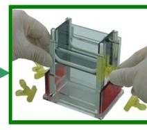
五.將玻片組架上電泳槽，須留意玻璃底部有無氣泡。
