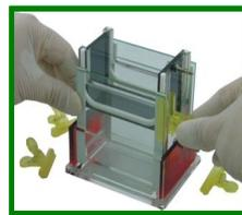
八.電泳分離完成後拔下電源接線，取下膠體玻片組。
