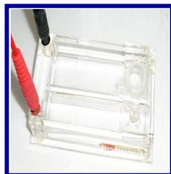
2.將適合的 Buffer 注滿槽內(約 100ml)放入組裝好的電離杯。
