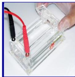
6.關掉電源,取出電離杯,將多餘的 Buffer 吸出最後只剩下小孔中的 Buffer 約 100ul。
