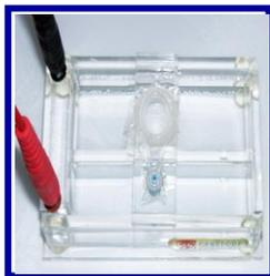
5.以電壓 100v 電泳 5min 後,樣品應已集中在半透膜上(可視情況延長時間,但不要造成過熱)。
