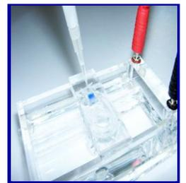
4.將電離杯用 Buffer 注滿,在小孔處再加入含鹽的 50%甘油(10ul)可防止樣品卡在半透膜上。
