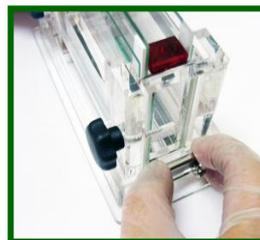
5. 待膠體凝固後，將側邊的扣片向外拉開。
