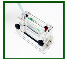
3. 注入膠體溶液，待凝固後，將水倒出。
