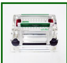
4. 注入第二層膠體溶液並置入齒梳。
